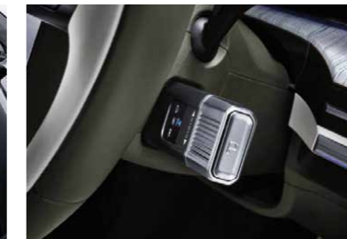
Cambio electrónico tipo columna (SBW)
