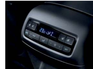
Sistema de aire acondicionado totalmente automático de control independiente en tres zonas
